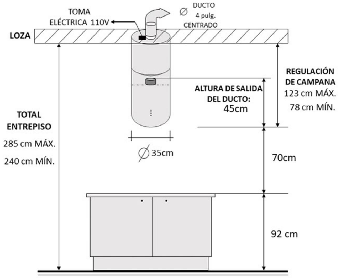
**!** **NOTA:** Si el techo es de Gypsum, es necesario fabricar una estructura, base cuadrada de 23x23cm, de ángulo de 1pulg, cuya parte superior irá fijada a la parte superior a la loza y cuya base quedará al ras del Gypsum, para anclar la isla. El costo de la estructura no está incluido en el valor de la campana.
