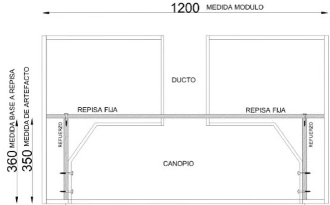
POR EL PESO DEL EQUIPO Y SU MÉTODO DE FIJACIÓN, SE REQUIERE UN REFUERZO PARA SOPORTE CON TORNILLOS: EL EFUERZO DEBE ESTAR ANCLADO A LA REPISA FIJA, DESDE ARIBA CON TORNILLOS SUPERIORES Ó CON UN ÁNGULO.
