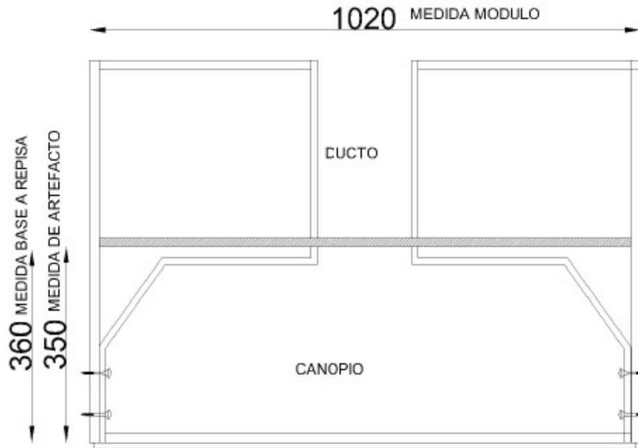
SI EL ANCHO TOTAL DEL MÓDULO (CON LATERAL DE 18MM) ES DE 1020MM, NO SE REQUIERE UN REFUERZO ADICIONAL EN EL COSTADO DEL MÓDULO.
