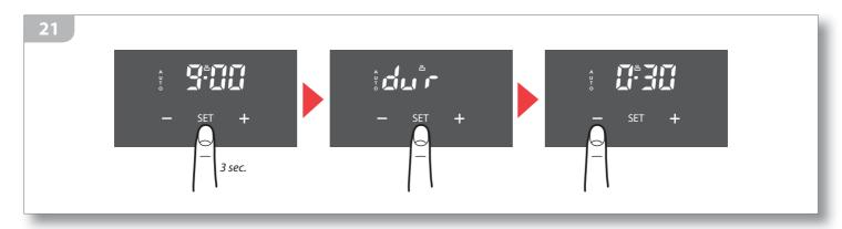
Il tempo impostato scade quando il valore raggiunge **00:00 h:min**. ed un SEGNALE ACUSTICO viene emesso.
